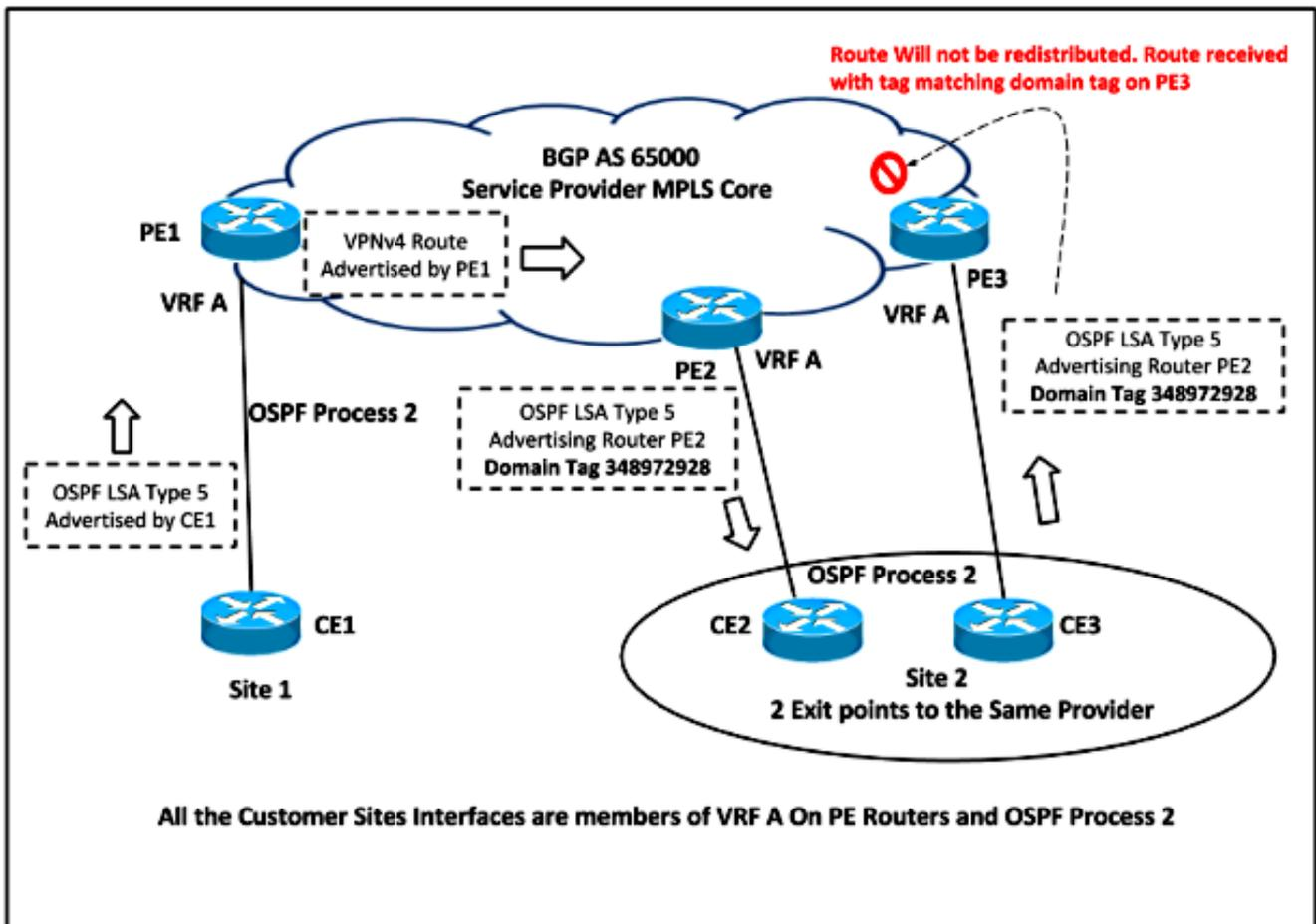
ネットワークトポロジに基づいて、PE2は、VPNv4ルートをOSPFに再配布するときに、タイプ5およびタイプ7LSAにドメインタグを設定します。DNビットがすでに設定されているため、このLSAはルート計算に考慮されませんが、ドメインタグも設定されており、VPN/VRFタグに一致するのでLSAは無視されます。したがって、ルートはOSPFに再配布されません。
