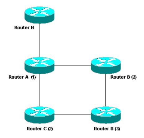
AとBの間のリンクで障害が発生すると、Bはそのネイバーに対してフィージブル サクセサが存在しなくなったことを通知するクエリを送信します。Dはそのクエリを受信し、他にフィージブル サクセサが存在するかどうかを確認します。存在しない場合、Dはルート計算を開始し、ルートがアクティブ状態になります。ただし、この場合、宛先Nに対し、Cのコスト(2)の方が Dの現在のコスト(3)よりも小さいため、Cがフィージブル サクセサとなります。Dはサクセサとして Cに切り替わることができます。Aと Cはこの変化の影響を受けないため、これには関与しないことに注意してください。
