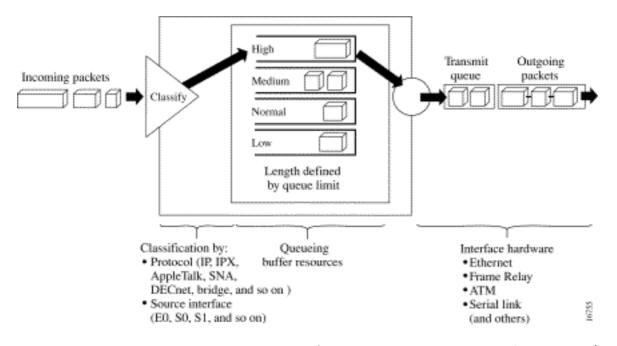
次に示すように、インターフェイス上でプライオリティ キューイングをイネーブルに設定すると、出力キューの表示が変わります。プライオリティ キューイングを適用する前のイーサネット インターフェイスでは、デフォルトのキュー サイズが 40 パケットである出力待機キューが 1 つだけ使用されます。
