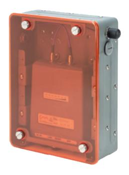
露天採掘や地下採掘を念頭に置いて設計されており、特に運搬トラック、ブルドーザ、ショベル、ドリル、ローダーに重点が置かれています。多くの場合、採掘現場の困難な環境条件下では無線デバイスは車両のキャビン内にのみ設置できます。そのため、最適長よりも長いアンテナケーブルが必要になり、RFのパフォーマンスが低下します。さらに、採掘車両のキャブは通常、無線機器の設置とメンテナンスのためのスペースが限られています。FM Shield Bracket は、これらすべての問題を解決します。FM Shield Bracket により、お客様は Cisco FM 無線デバイスを車外のできるだけアンテナに近い場所に設置し、RF 損失を抑えて伝送範囲を拡大することができます。通常どおり、カテゴリ 5/6 ケーブルを使用するか、専用のデータおよび DC 電源接続を使用して、Power over Ethernet (PoE)によって電力と接続を提供できます。
