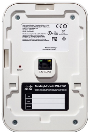
図 4. WAP361 Wireless-AC/N デュアル無線ウォールプレートアクセスポイントの側面パネル
