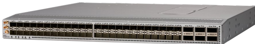
図 1. Cisco Nexus 93180YC-FX3H スイッチ
