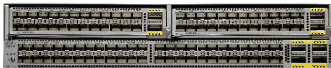
図 3 Cisco Nexus 56128P のポート図(背面)
