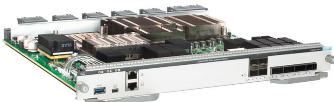
図 2. C9400X-SUP-2 スーパーバイザエンジン
