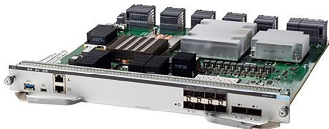
図 5. C9400-SUP-1 スーパーバイザエンジン
