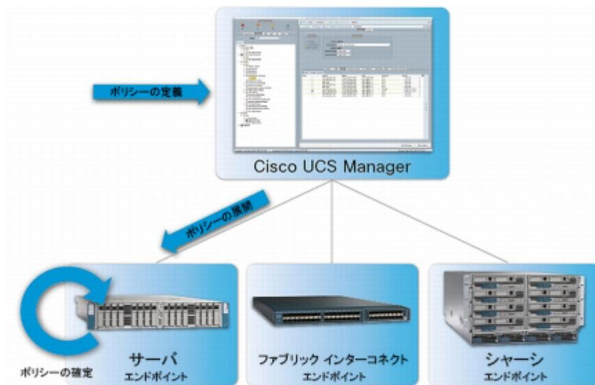
Cisco UCS Central Software から見ると、受け手は Cisco UCS Central Software で登録されている個々の Cisco UCS Manager インスタンスです。Cisco UCS Central Software の場合、グローバル Cisco UCS サービス プロファイルは一元的に定義され、Cisco UCS Central Software に設定された方法に従って、Cisco UCS Manager インスタンスに渡されます(図 4)。
