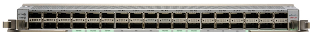
図 1. Cisco NCS 5500 シリーズ 100GE 24 ポートおよび 40GE 12 ポートのベースラインカード
