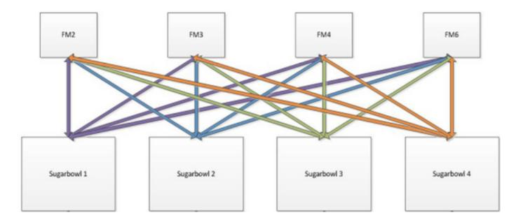
Quando il traffico ricevuto da un ASIC deve passare a un altro ASIC o scheda di linea, deve essere inviato all'infrastruttura tramite un modulo fabric. L'ASIC in entrata selezionerà uno dei collegamenti Ethernet ai moduli fabric in base a un hash delle intestazioni del pacchetto e al numero di collegamenti Ethernet disponibili per l'ASIC.
