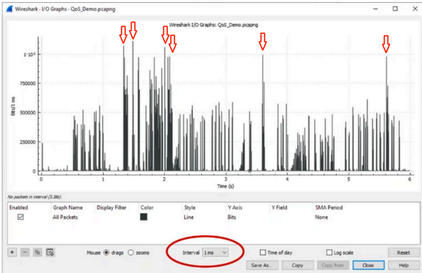
Figura 8. Mostra come identificare il potenziale traffico di microburst nel grafico I/O.
