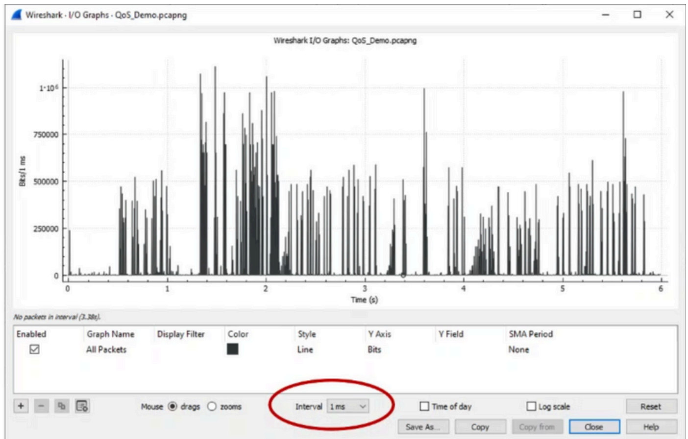
Figura 7. Mostra il grafico I/O del sottoinsieme esportato dell'acquisizione del pacchetto.
