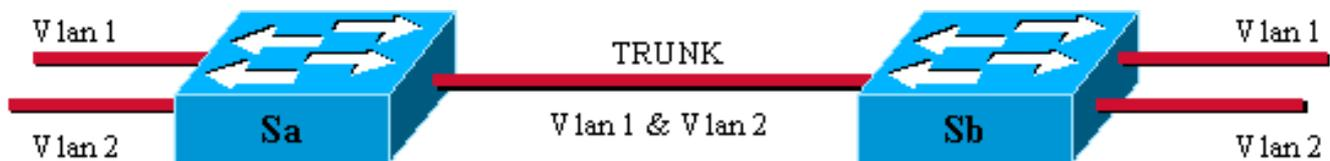
In questo modo, l'unico collegamento fisico tra i due switch può trasmettere il traffico di tutte le VLAN. A tale scopo, ogni frame inviato sul collegamento viene contrassegnato dalla scheda Sa in modo che Sb conosca la VLAN a cui appartiene. Esistono diversi schemi di tagging. I più comuni per i segmenti Ethernet sono:
