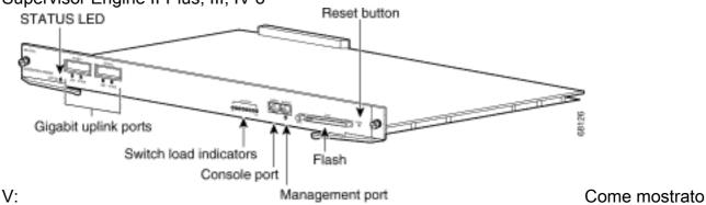
nell'esempio, se si intende collegare direttamente la porta 10/100 MGT al PC/router, utilizzare un cavo dritto. Se si collega un altro switch, utilizzare un cavo crossover.
