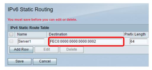
Passaggio 5. Inserire il valore del prefisso in bit nel campo *Lunghezza prefisso*. Numero di bit di prefisso nell'indirizzo IPv6 che definiscono la subnet di destinazione. nell'esempio, viene immesso 64.
