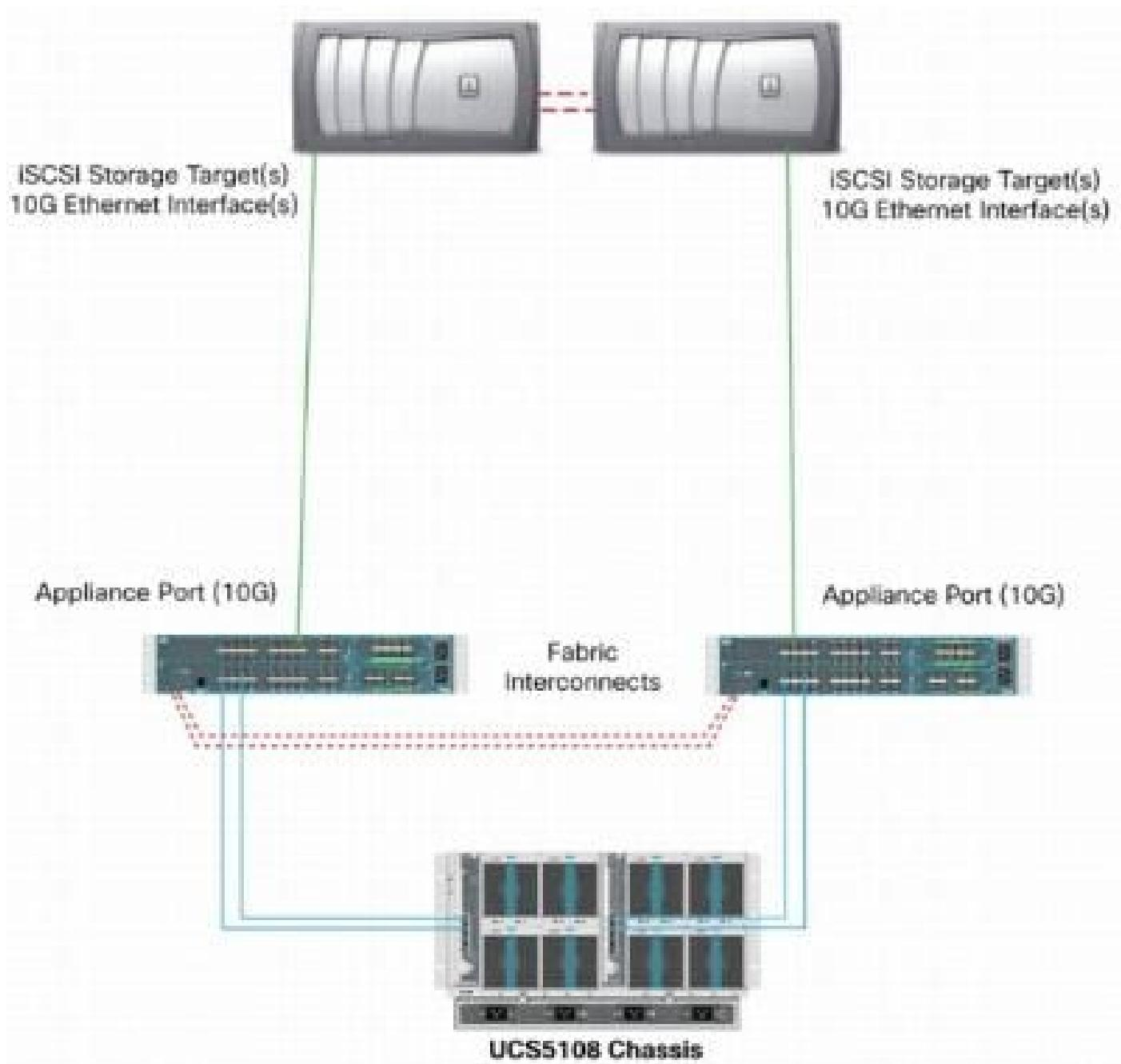
Che la rete upstream sia 1 GbE o 10 GbE, l'uso di frame jumbo (ad esempio una MTU di 9000) migliora le prestazioni in quanto riduce il numero di frame singoli da inviare per una determinata quantità di dati e riduce la necessità di separare i blocchi di dati iSCSI in più frame Ethernet. Inoltre, riducono l'utilizzo della CPU di host e storage.
