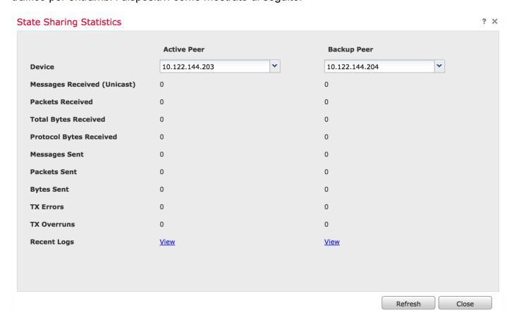
Quando la condivisione dello stato è abilitata e un'interfaccia sul membro Attivo non è attiva, tutte le connessioni TCP vengono trasferite al dispositivo di standby che è diventato Attivo.
