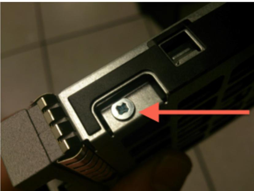
*Figura: Quattro viti a testa Phillips fissano l'unità alla slitta: due per lato.*
