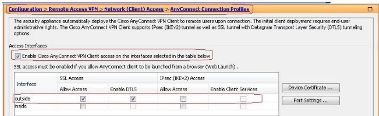
Clic Apply. Scegli Configuration > Remote Access VPN > Network (Client) Access > Anyconnect Client Software > Add per aggiungere l'immagine del client VPN Cisco AnyConnect dalla memoria flash dell'ASA, come mostrato.
