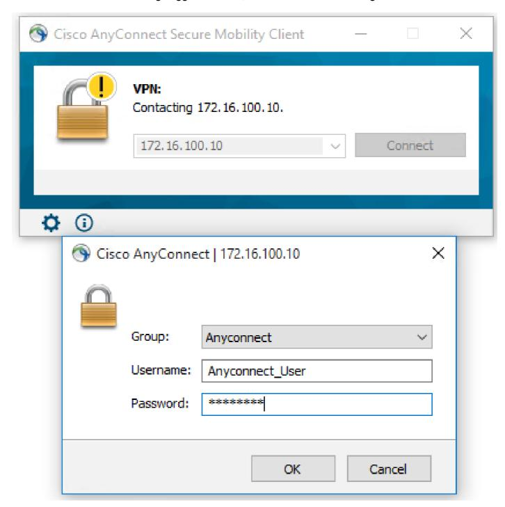
A partire dalla versione FDM 6.5.0, non è possibile monitorare gli utenti Anyconnect tramite l'interfaccia utente di FDM. L'unica opzione è monitorare gli utenti Anyconnect dalla CLI. È possibile utilizzare la console CLI della GUI di FDM anche per verificare che gli utenti siano connessi. Utilizzare questo comando, Show vpn-sessiondb anyconnect.
