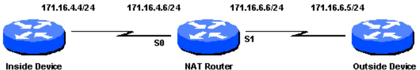
In questo esempio di configurazione, il dispositivo interno ha un percorso predefinito del router NAT. Il dispositivo esterno dispone di un percorso statico verso un indirizzo a cui viene convertito il dispositivo interno. Il router NAT ha la seguente configurazione NAT:
