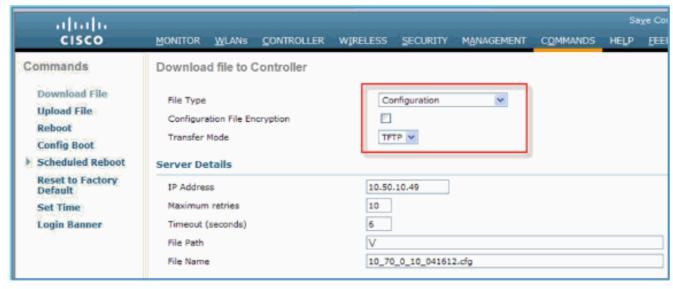
Una volta scaricato il file di configurazione sul controller, il controller viene ripristinato e avviato.
