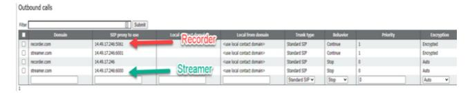
Nella Figura viene illustrata una chiamata al componente del registratore tramite un controllo di chiamata, ad esempio Cisco Unified Communications Manager (CUCM) o Expressway.
