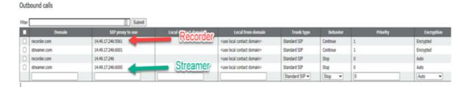
Nella Figura viene illustrata una chiamata al componente del registratore tramite un controllo di chiamata, ad esempio Cisco Unified Communications Manager (CUCM) o Expressway.
