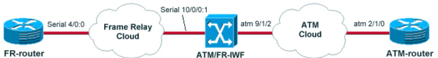
**Nota:** il router ATM-E è un router 7500 che usa un PA-A3-OC3MM in un VIP2-50 con versione 12.1(13)E. Il router FR è un router 7200 con versione 12.1(17). Lo switch ATM/FR-IWF è uno switch Catalyst 8540MSR con versione 12.1(12c)EY.
