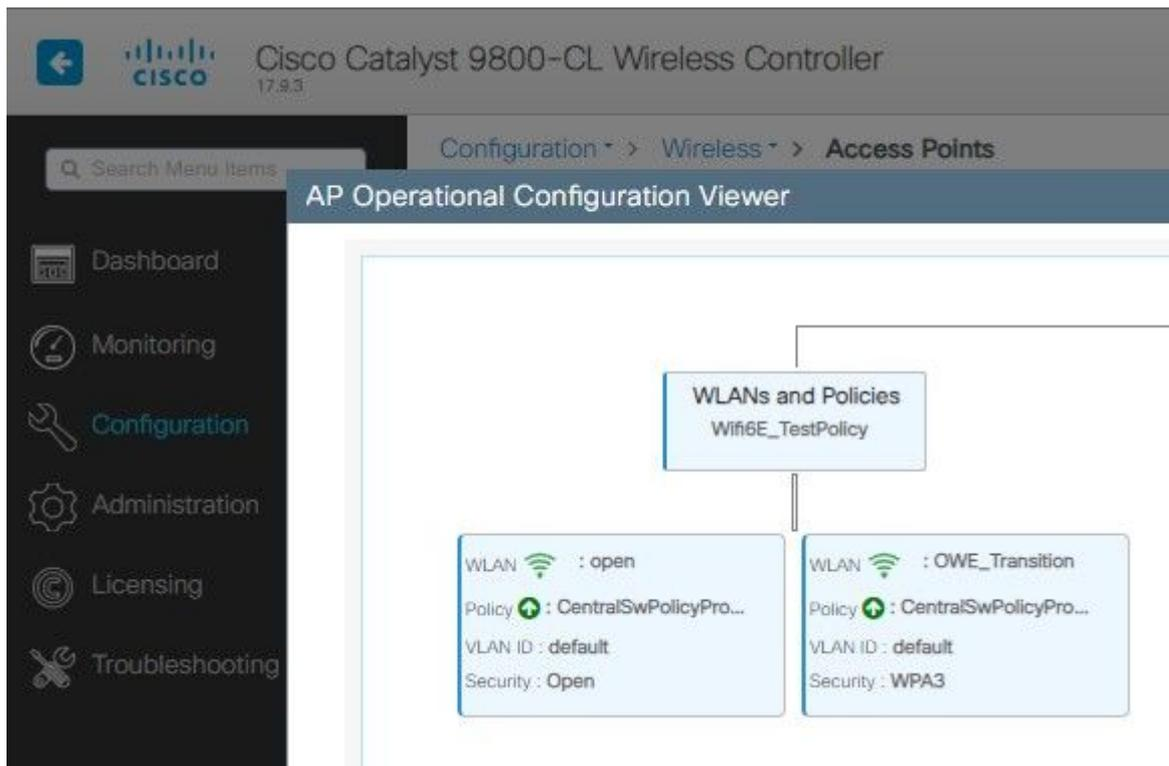
Lorsqu'il est activé, le point d'accès ne signale que les balises avec un SSID ouvert mais transporte un élément d'information (IE) du mode de transition OWE. Lorsqu'un client capable d'ouvrir amélioré se connecte à ce SSID, il utilise automatiquement OWE pour chiffrer tout le trafic après l'association.
