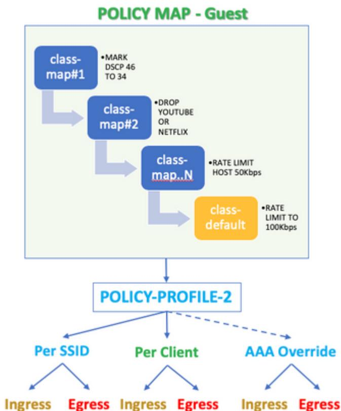
Dans cet exemple, la stratégie QoS doit être appliquée par SSID dans les deux sens, en entrée et en sortie, vers le profil de stratégie qui est lié au WLAN invité.
