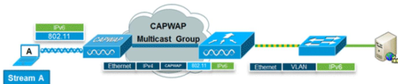
VideoStream permet une diffusion vidéo multidiffusion sans fil fiable et évolutive, envoyant le flux à chaque client dans un format monodiffusion. La conversion de multidiffusion en monodiffusion (de L2) se produit au niveau du point d'accès, fournissant ainsi une solution évolutive. Le contrôleur envoie le trafic vidéo IPv6 à l'intérieur d'un tunnel de multidiffusion CAPWAP IPv4 qui permet une distribution réseau efficace au point d'accès.
