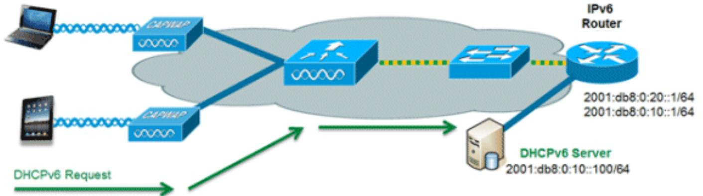
L'utilisation de DHCPv6 n'est pas requise pour la connectivité du client IPv6 si SLAAC est déjà déployé. Il existe deux modes de fonctionnement pour DHCPv6, appelés **Stateless** et **Stateful**.
