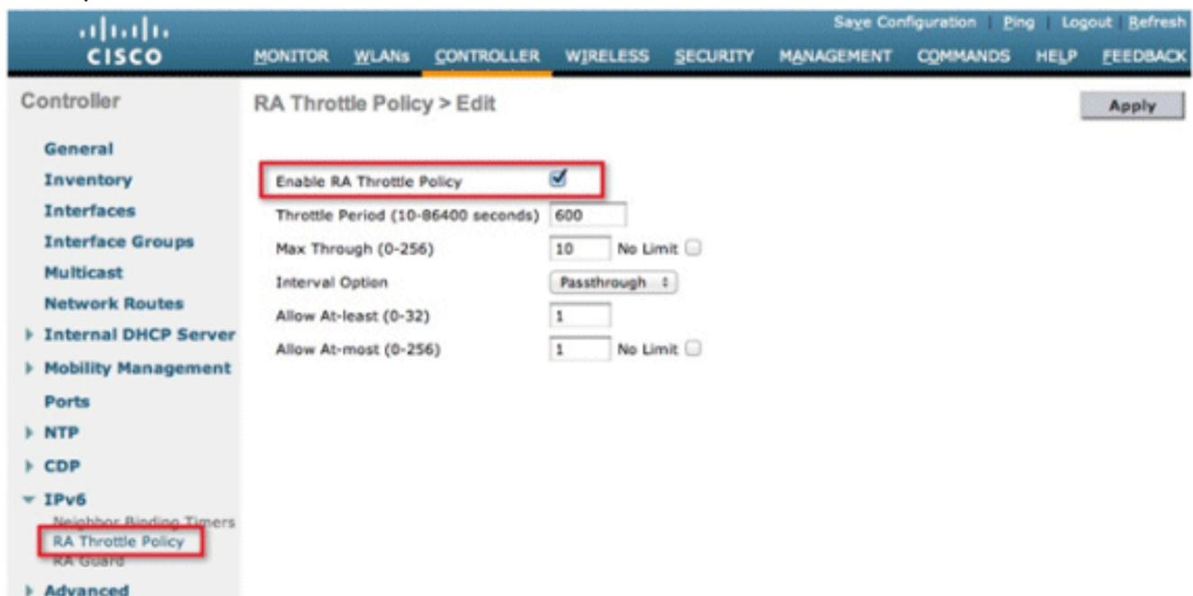
**Remarque** : en cas de limitation RA, seul le premier routeur IPv6 est autorisé à passer. Pour les réseaux avec plusieurs préfixes IPv6 desservis par différents routeurs, la limitation RA doit être désactivée.
