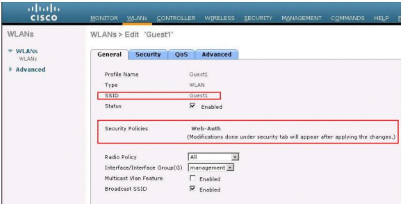
En supposant que vous disposiez d'un serveur DHCP interne, le client se connecte au WLAN Guest1 et acquiert une adresse IP. Lorsque le client tente d'accéder à une URL (par exemple, www.cisco.com), puisque le proxy manuel est activé sur le navigateur client, le contrôleur utilisant la fonctionnalité proxy d'authentification Web répond avec une page Web invitant l'utilisateur à modifier les paramètres du proxy Internet pour détecter automatiquement les paramètres du proxy.
