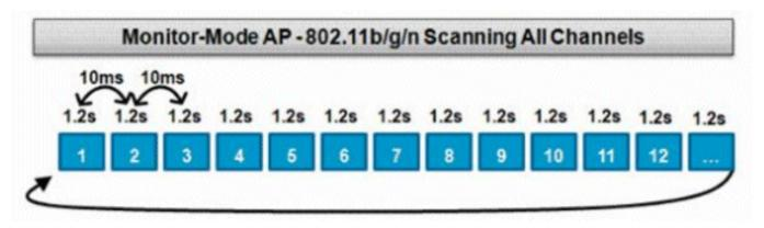
Ce graphique est une représentation de l'algorithme de balayage hors canal pour un point d'accès en mode moniteur dans la bande de fréquences de 2,4 GHz. Une opération similaire est effectuée en parallèle sur la radio 5 GHz si le point d'accès en possède une.
