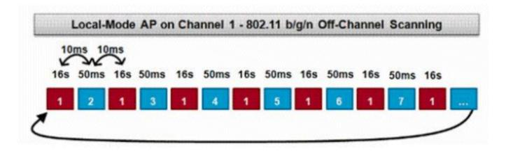
Ce graphique est une représentation de l'algorithme de balayage hors canal pour un point d'accès en mode local dans la bande de fréquences de 2,4 GHz. Une opération similaire est effectuée en parallèle sur la radio 5 GHz si le point d'accès en possède une. Chaque carré rouge représente le temps passé sur le canal d'accueil des points d'accès, tandis que chaque carré bleu représente le temps passé sur les canaux adjacents à des fins d'analyse.
