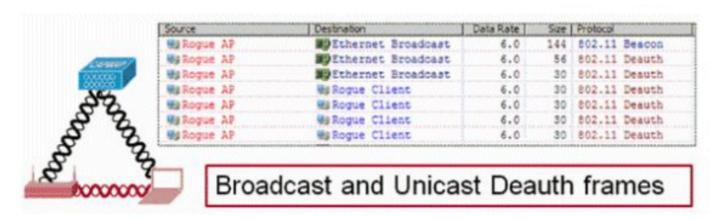
Les paquets de confinement sont envoyés au niveau de puissance du point d'accès géré et au débit de données activé le plus faible.
