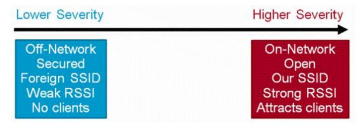
Les règles de classification des systèmes non fiables vous permettent de définir un ensemble de conditions marquant un système non fiable comme étant malveillant ou convivial. Ces règles sont configurées au niveau du PI ou du WLC, mais elles sont toujours exécutées sur le contrôleur à mesure que de nouveaux routeurs sont découverts.
