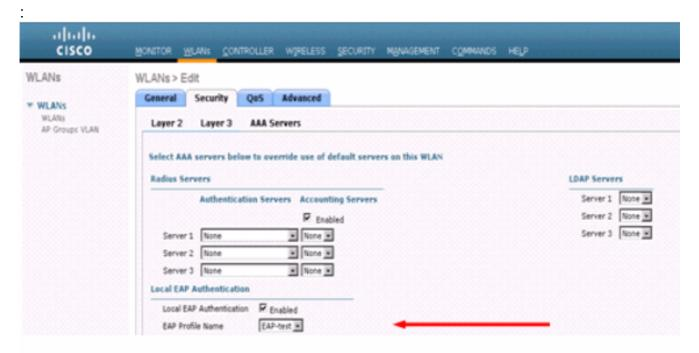
Vous pouvez également émettre la commande de configuration CLI **config wlan local-auth enable** *rofile-name> <wlan-id> comme indiqué ici :*
