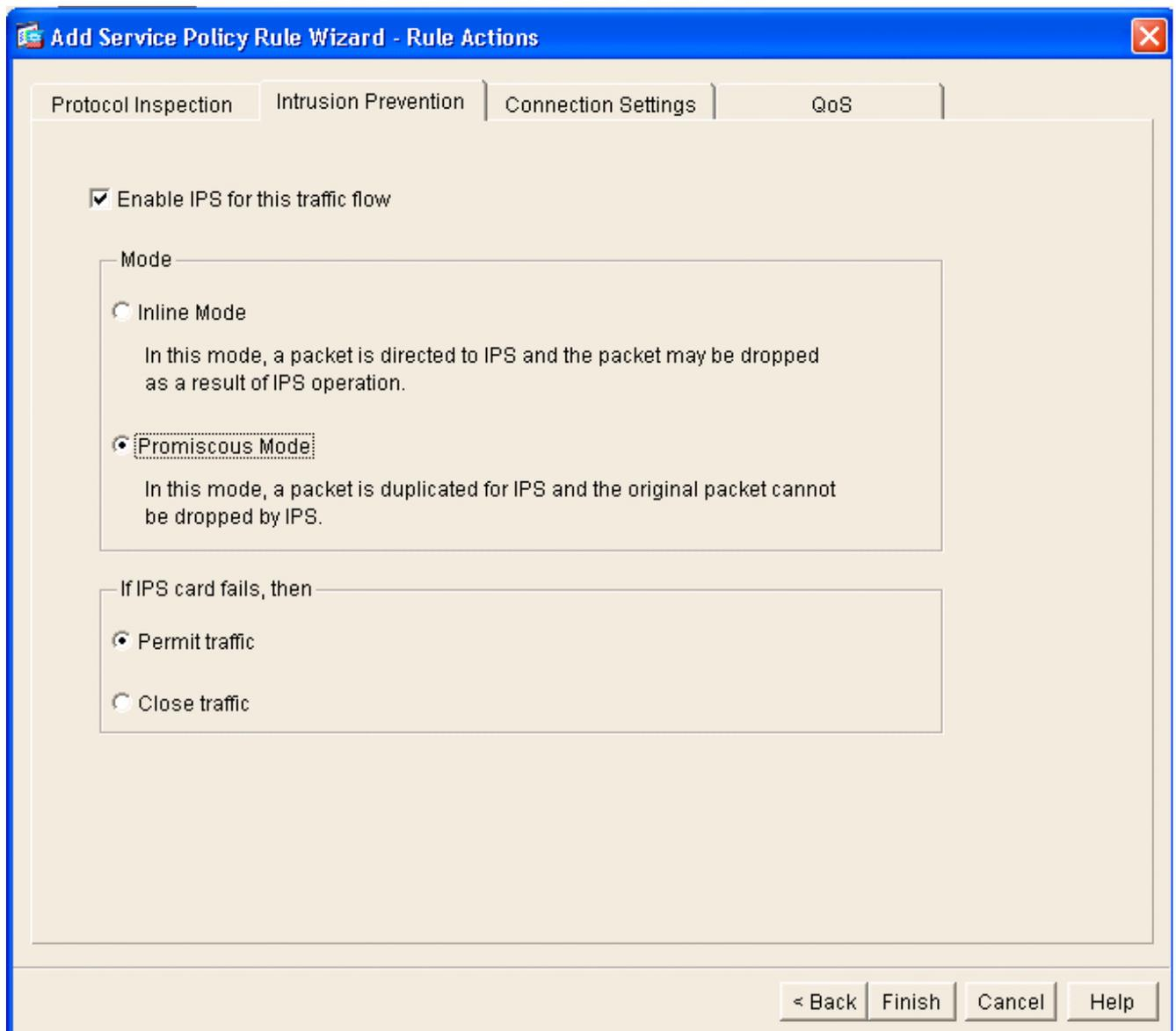
7. L'ASA est maintenant configuré pour envoyer le trafic au module IPS. Cliquez sur **Enregistrer** sur la ligne supérieure afin d'écrire les modifications dans l'ASA.
