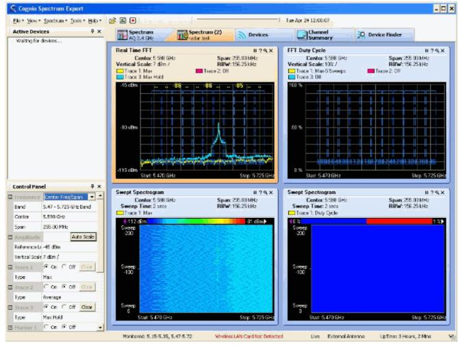
6. Utilisez les paramètres de démarrage/d'arrêt disponibles dans le Panneau de configuration afin de zoomer dans le tracé de signal. Vous pouvez ainsi obtenir plus de détails sur le nombre total de canaux affectés et la puissance du signal
