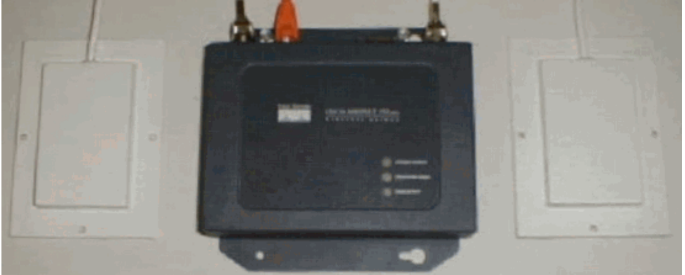
Figure 4 – Périphériques sans fil de la gamme Cisco Aironet 350 avec deux antennes à plaque de 6.0 dBi pour la diversité
