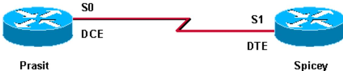
L'encapsulation série par défaut est Cisco High-Level Data Link Control (HDLC). Vous devez configurer explicitement la méthode d'encapsulation X.25 à l'aide de la commande **encapsulation x25**. L'option **dce** spécifie le fonctionnement en tant que périphérique DCE X.25 logique.
