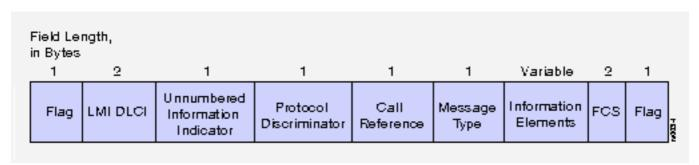
Notez que le DLCI est long de deux octets et que le paquet entier est long de 10 octets plus une quantité variable de données pour les éléments d'information (IE). Nous pouvons afficher la partie IE des paquets d'état complet du circuit virtuel permanent (PVC) à l'aide de la commande **debug frame-relay lmi**. (Il ne s'agit que des messages d'état complets du commutateur de trame ; vous voyez également des messages d'état réguliers à l'aide de cette commande **debug**.)
