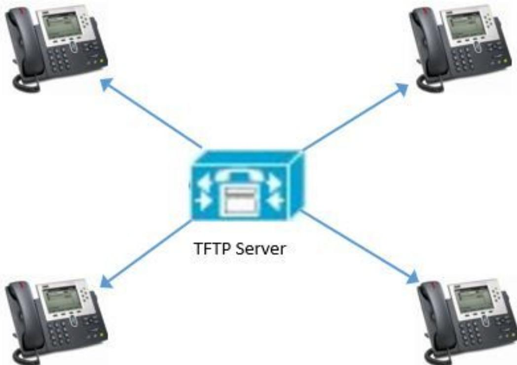
Figure 2 a). Mise à niveau traditionnelle du micrologiciel
