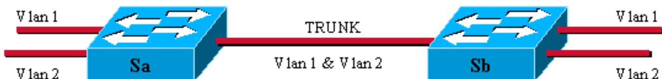
Ici, la liaison physique unique entre les deux commutateurs est capable de transporter le trafic pour n'importe quel VLAN. Pour ce faire, chaque trame envoyée sur la liaison est étiquetée par Sa afin que Sb connaisse le VLAN auquel elle appartient. Il existe différents schémas d'étiquetage. Les segments Ethernet les plus courants sont les suivants :
