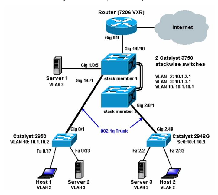
Le schéma ci-dessus montre un petit exemple de réseau avec la pile de Catalyst 3750s fournissant le routage inter-VLAN entre les divers segments.
