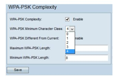
Étape 2. Cochez la case **Activer** dans le champ Complexité WPA-PSK pour permettre au point d'accès de vérifier la complexité des nouvelles clés pré-partagées WPA.
