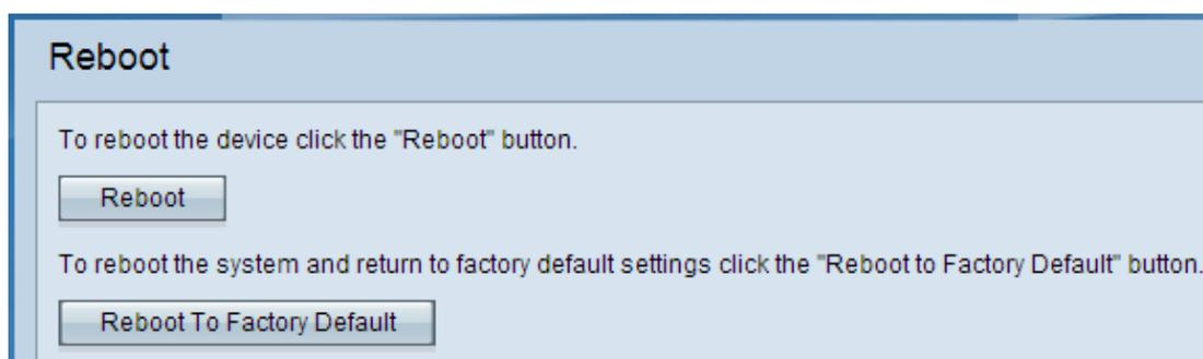
Étape 2. Cliquez sur **Reboot To Factory Default** pour redémarrer le point d'accès et rétablir les paramètres d'usine par défaut du périphérique. Une fois redémarrée en usine par défaut, toutes les configurations enregistrées seront perdues.
