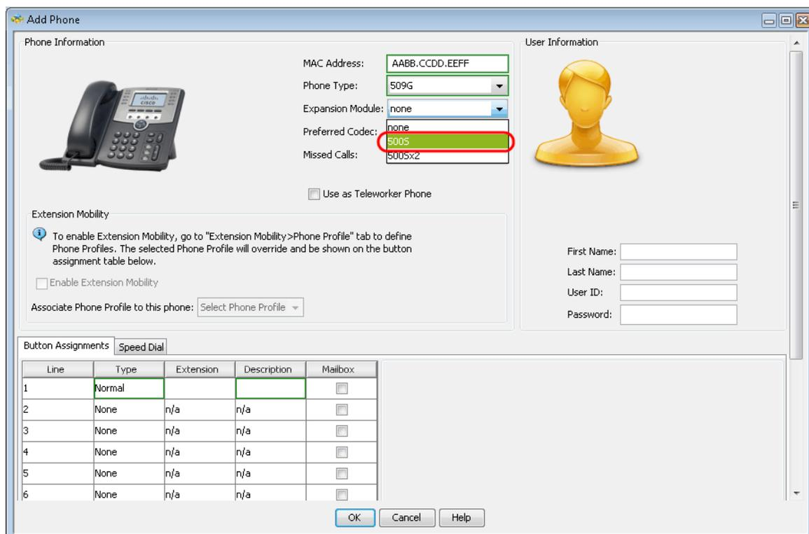
Étape 5. Dans la liste déroulante Module d'extension, sélectionnez le module d'extension connecté au téléphone IP de la gamme SPA500.
