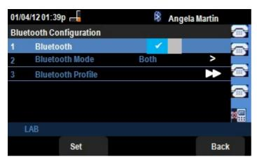
Étape 4. Lorsque l'option Profils Bluetooth est sélectionnée, appuyez sur la touche de navigation **Flèche droite**.
