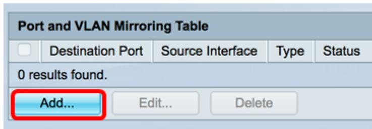
Étape 3. Dans la fenêtre Add Port and VLAN Mirroring, cliquez sur le menu déroulant Destination Port (Port de destination) pour sélectionner le port auquel l'ordinateur qui exécute Wireshark est connecté.
