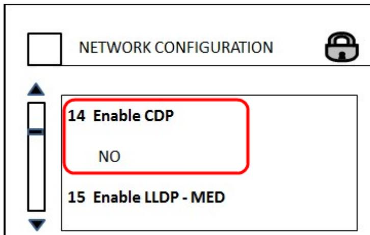
Étape 1. Sur l'interface du téléphone, sélectionnez **Paramètres > Configuration réseau > Activer CDP**.
