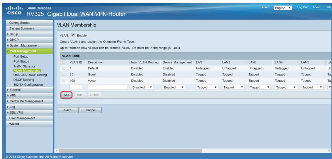
Étape 4. Entrez un numéro de VLAN dans le champ *VLAN ID*. Les ID de VLAN doivent être compris entre 4 et 4 094. Dans cet exemple, 200 est utilisé pour les données comme ID de VLAN. Entrez ensuite une description pour le VLAN dans le champ *Description*. Les données sont entrées comme exemple de description. Cliquez ensuite sur **Enregistrer**.
