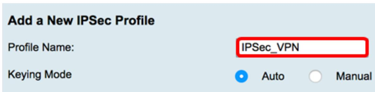
Étape 4. Cliquez sur une case d'option pour déterminer la méthode d'échange de clés que le profil utilisera pour s'authentifier. Les options sont les suivantes :
