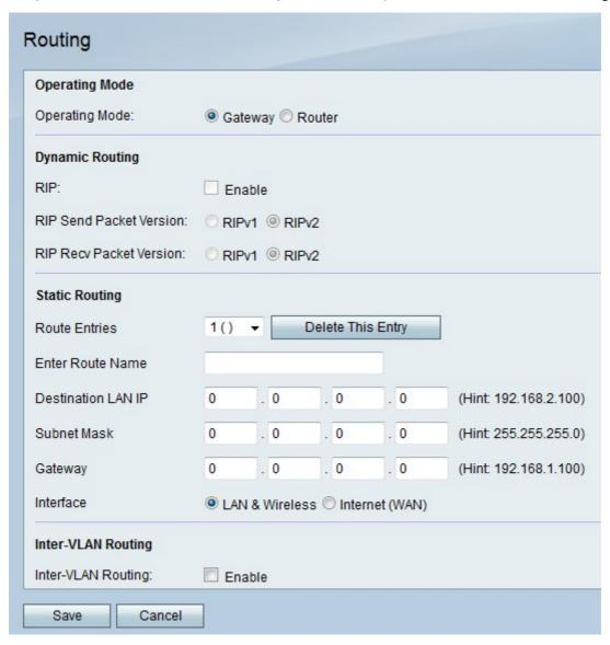
Étape 2. À droite du mode de fonctionnement, cliquez sur la case d'option **Gateway** pour configurer le routeur RV110W en tant que routeur et pour connecter le réseau à Internet, ou cliquez sur la case d'option **Router** pour configurer le routeur RV110W pour qu'il agisse
