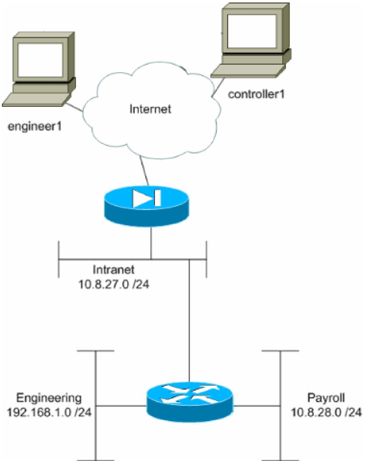
Dans cet exemple de configuration, un petit réseau d'entreprise avec trois sous-réseaux est supposé. Ce schéma illustre la topologie. Les trois sous-réseaux sont Intranet, Ingénierie et Paie. L'objectif de cet exemple de configuration est d'autoriser le personnel de paie à accéder à
