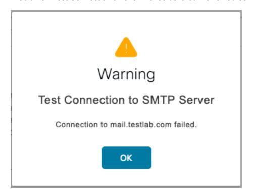
Solution : Vérifiez la configuration du port du serveur SMTP. Vérifiez si le nom du serveur SMTP peut être résolu par le serveur DNS configuré sur ISE.
