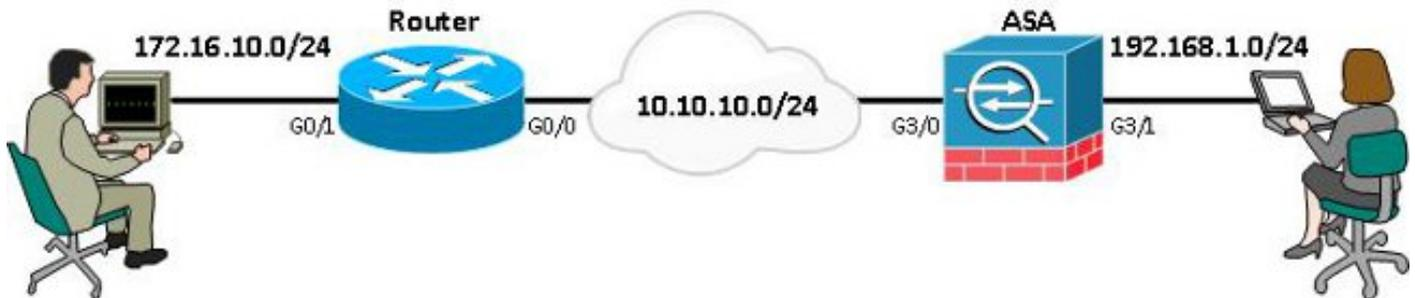
**Remarque :** la configuration inclut une connexion directe du routeur et de l'ASA. Ils peuvent être séparés par de nombreux sauts. Si oui, assurez-vous qu'il existe une route pour accéder à l'adresse IP de l'homologue. La configuration suivante ne détaille que le chiffrement utilisé.
